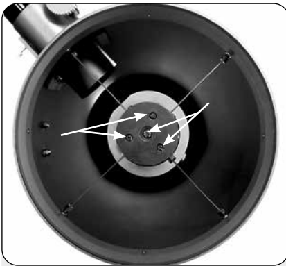
Fig. 31b: Los cuatro tornillos de colimación de la carcasa del espejo secundario.
