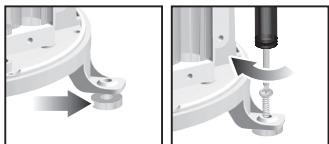
**NOTA** Para obtener mejores resultados, asegúrese de que la base está en posición horizontal a fin de maximizar el drenaje del agua recogida.
