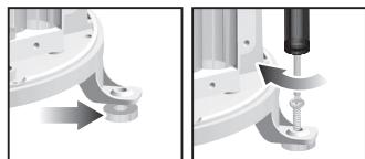
**NOTERA** För bästa resultat, se till att basen är horisontell så maximal dränering av allt insamlat regn sker.
