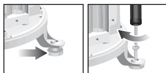
**HINWEIS** Sie müssen die Basis des Sensors unbedingt horizontal ausrichten, um zuverlässige Messwerte zu gewährleisten um einen vollständigen Ablauf des gesammelten Regenwassers zu gewährleisten.
