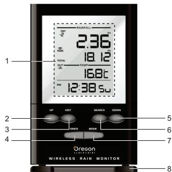
1. Pantalla LCD de cuatro líneas para mostrar la precipitación total, la precipitación actual o el historial de precipitaciones, la temperatura interior/exterior y el reloj/calendario.
