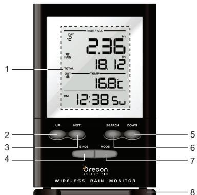
1. Vierzeilige LCD-Anzeige: für die Anzeige der Gesamtniederschlagsmenge, der aktuellen Niederschlagsmenge oder des Niederschlagsverlaufs, der Innen/Außentemperatur und der Uhrzeit/des Kalenders.
