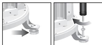
**注** 要得到最好的效果，请确保底部是水平放置，以让任何收集到的雨水能以最大量地排出。
