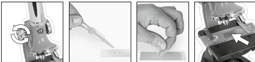
Voor de normale observatie zet je de microscoop op een goed verlichte plaats (raam, bureaulamp). Draai de scherpteregeling (2) tot aan de bovenste aanslag en stel de objectieffrevolver (3) op de kleinste vergroting in.
