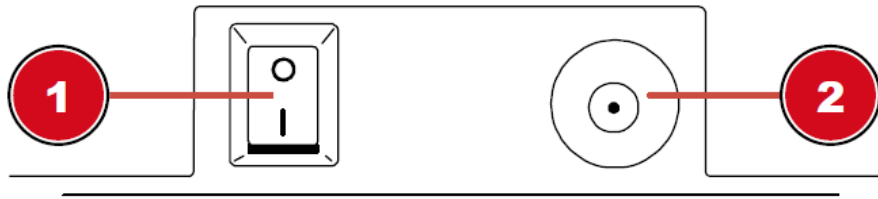
Illustration 3 : Prise de connexion CC pour connecteur coaxial / barillet
