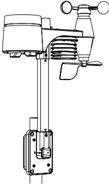
A. Montage am Mast (Mastdurchmesser 1"~1,3")
