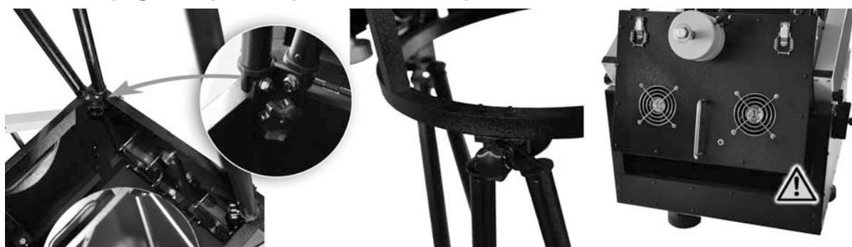
Fig. 3: Montage des entretoises et insertion de la cage du miroir principal dans la boîte à bascule
