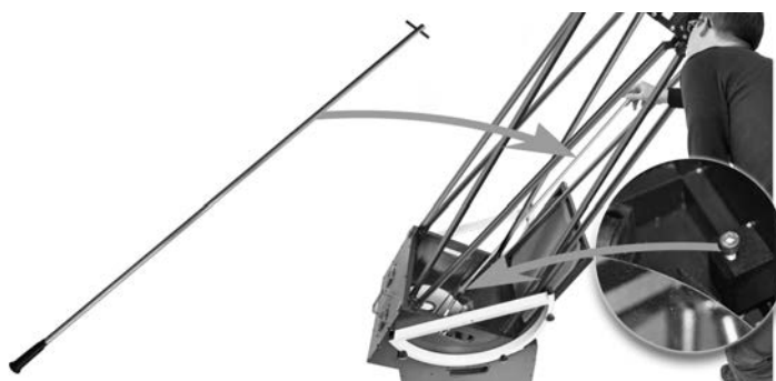
Fig. 6: Réglage du miroir principal avec un outil spécial
