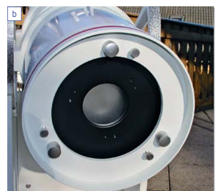
Abb. 3: Der Blick auf den Tubus von vorne (a) und hinten (b) zeigt die Fangspiegel-Aufhängung und die Justierschrauben.
