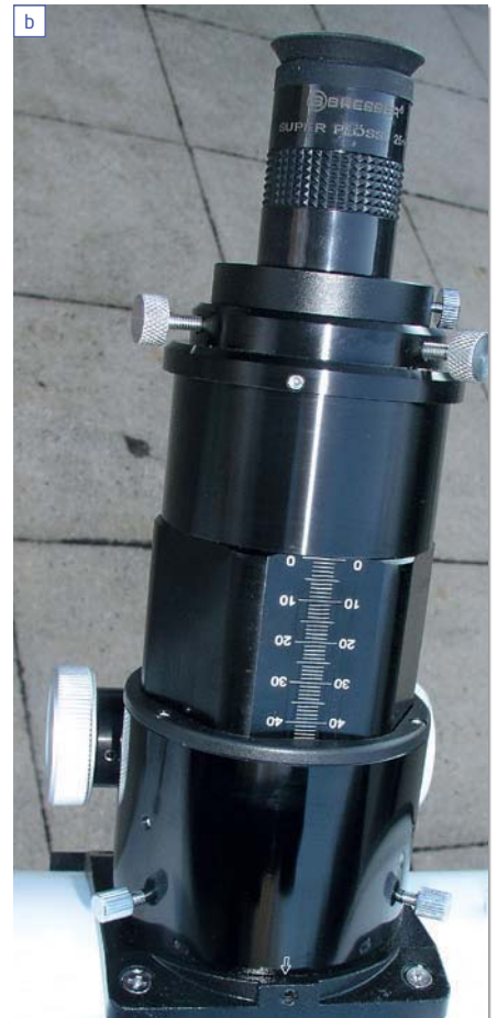
Abb. 2: Für die monokulare Beobachtung muss die Verlängerungshülse verwendet (a), für die binokulare Verwendung entfernt werden (b).
