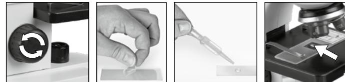
Pour une observation normale, tu dois poser ton microscope sur un emplacement bien éclairé (près d'une fenêtre ou d'une lampe). La molette de mise au point (2) doit être vissée jusqu'à sa butée supérieure et le porte-objectifs réglé sur le plus petit grossissement.
