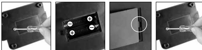
Для наблюдений с подсветкой (6) вставьте 2 батарейки AA 1,5 В в батарейный отсек (8), расположенный в основании микроскопа (7). Батарейный отсек можно открыть с помощью крестовой отвертки. При установке батареек соблюдайте полярность (обозначена знаками +/ -). Затем поставьте крышку батарейного отсека на место, сначала вдвинув выступ крышки в маленький паз, и закрутите винт.
