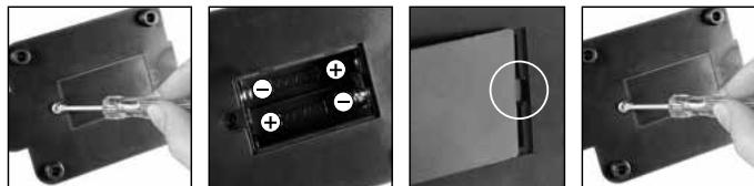
Para la observación con la fuente de luz electrónica (6) necesita insertar 2 AA pilas de 1.5V, en el compartimento de las pilas (8) en la base del microscopio (7). El compartimento de las pilas se abre usando un destornillador Phillips. Inserte las pilas con la polaridad correcta (+/- indicación). Coloque primero la tapa de las pilas en la pequeña abertura para que la tapa encaje perfectamente. Ahora puede apretar el tornillo.
