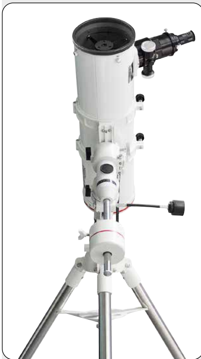
Abb. 16b: Die parallaktische Grundposition von Norden gesehen. Die RA-Achse und der parallele Tubus zeigen dabei zum Polarstern (Polaris).
