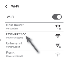
(d) Wählen Sie den Namen des WLAN-Netzwerks der Basistation (der Name beginnt immer mit PWS-), um Ihr Smartphone mit der Basistation zu verbinden. Gehen Sie dann zurück zur WSLink-App.
