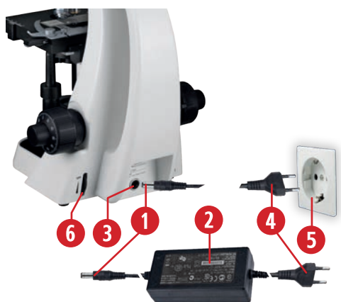
Fig. 2. : Établir la connexion secteur et ajuster l'éclairage.
