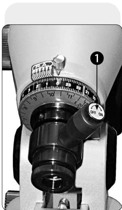
Fig. 6: Vista dettagliata del cercatore polare con interruttore rotativo (ON/OFF)
