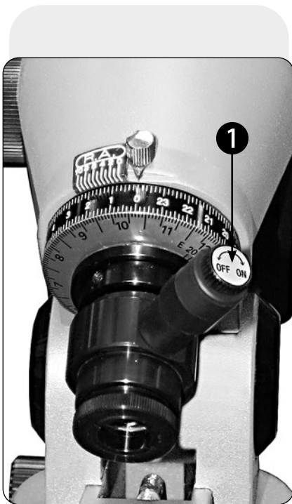
Fig. 6: Vista detallada del visor polar con interruptor giratorio (ON/OFF)
