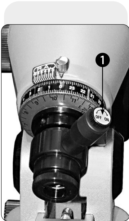
Abb. 6: Detailansicht Polsucherfernrohr mit Drehschalter (ON/OFF)
