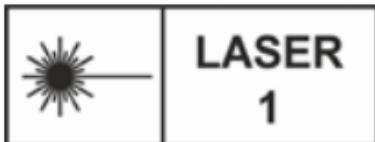
Tento přístroj je klasifikován jako LASEROVÝ VÝROBEK TŘÍDY 1 podle EN / IEC 60825-1-2014.
