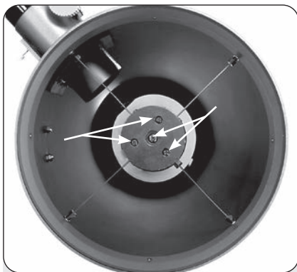
Abb. 31b: Die vier Kollimationsschrauben im Fangspiegelgehäuse
