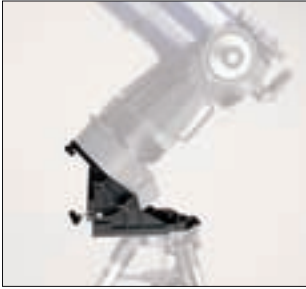
Abb. 79: Dieses Teleskop mit azimutaler Gabelmontierung ist auf einer Polhöhenwiege montiert
