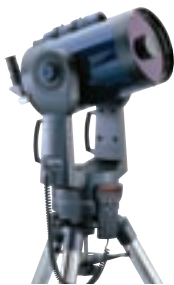
Abb. 60: Spiegel-Fortgeschrittenenteleskop, Bauart Schmidt-Cassegrain mit 203 mm Öffnung.
